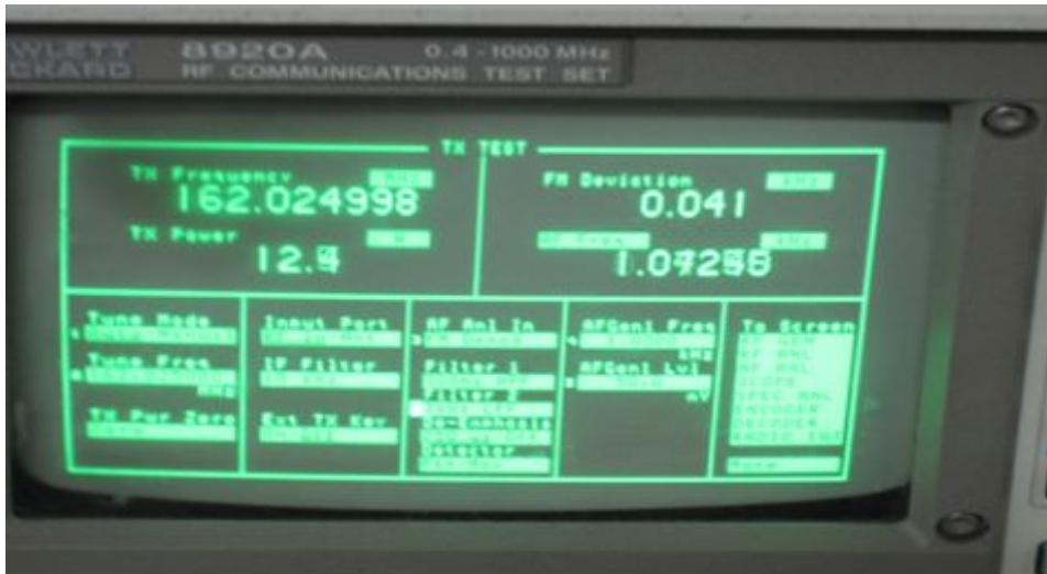
<그림 4-18> 주파수 허용편차 측정
