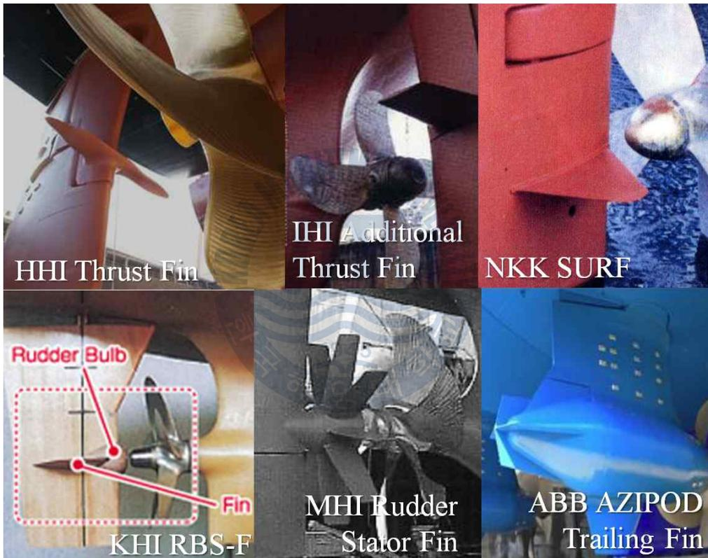
Fig. 3.25 Rudder fin type
