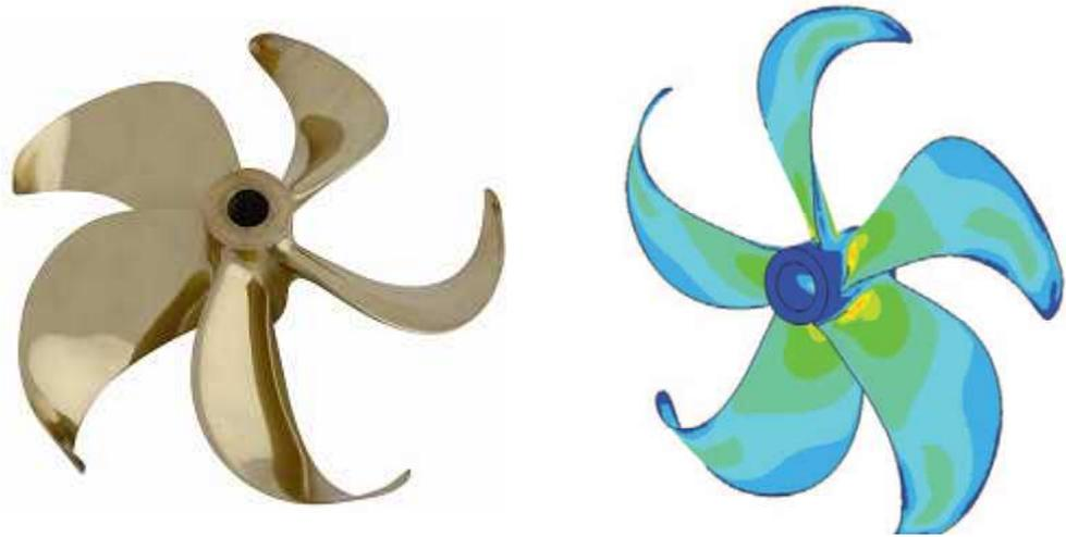
Fig. 3.3 Kappel propeller
