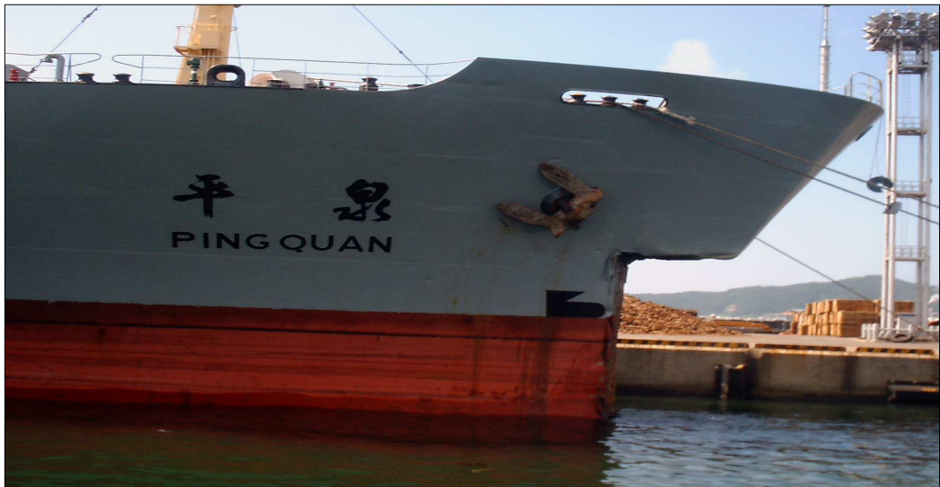
<그림 3-10> PING QUAN호의 감천 서방파제 충돌 후 피해 사진
