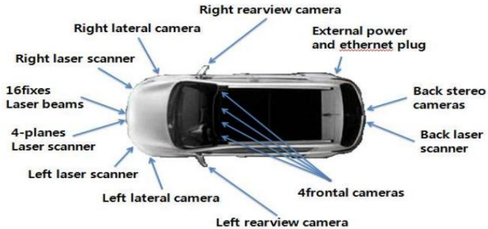
[그림 2-7] 무인자율차량을 위한 환경 인지용 센서
