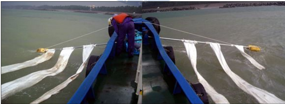
<그림 4-11> 선박을 이용한 유흡착재 예인 회수(MDPC실시)
