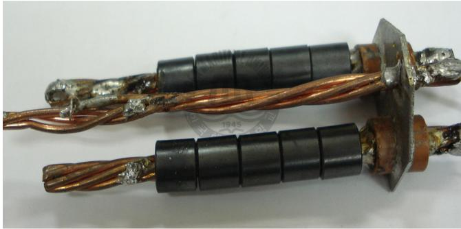
그림 5. 1 제작된 대전력용 차단기 내의 EMC 필터의 사진
