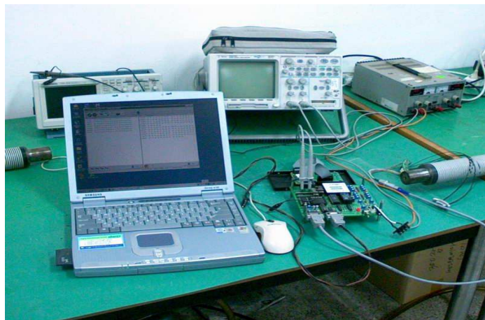
그림 4.1 RS-485 기반의 실험 장치 구성
