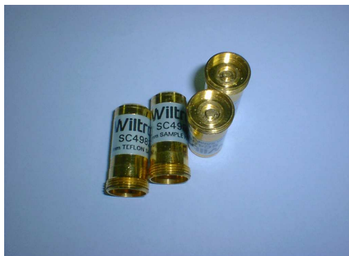
그림 2.10 Wiltron사의 Sample Holder Fig. 2.10 Sample Holder of Wiltron.
