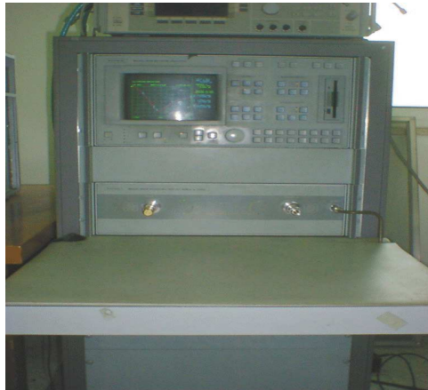
그림 2.9 Model 360B 네트워크 아날라이저 Fig. 2.9 Model 360B Network Analyzer.
