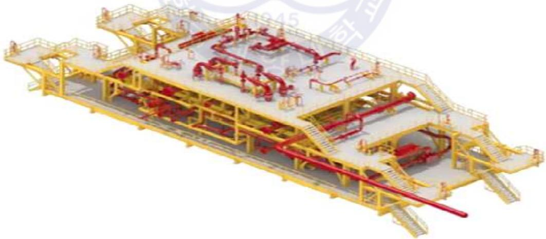
Fig. 5.6 3D Model of B Module
