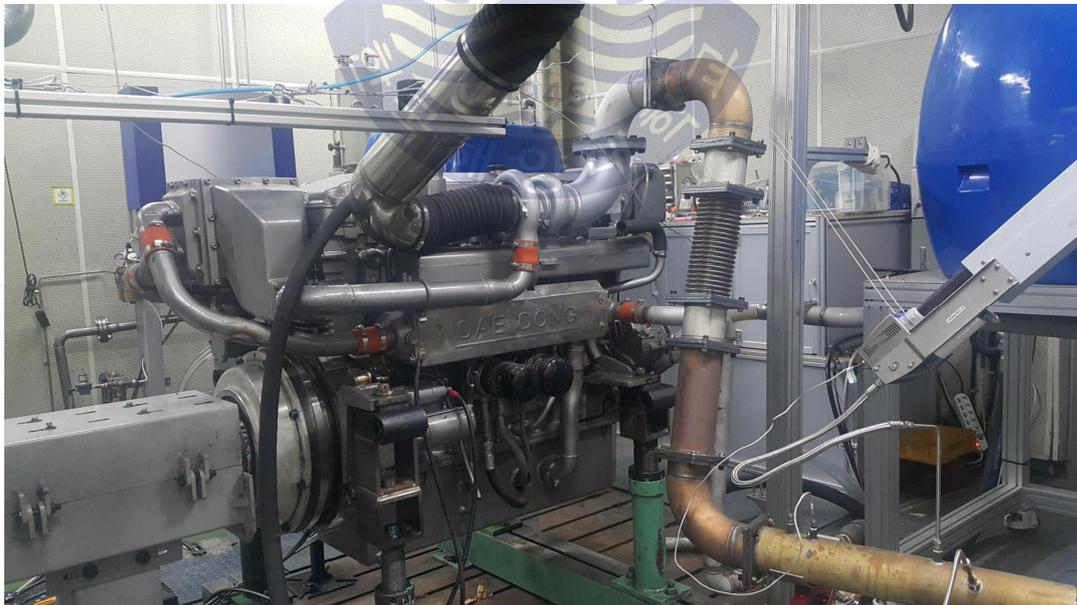
**Fig. 4.11** 대동 DD6CAM 엔진시험 및 배기가스측정 장치의 전경
