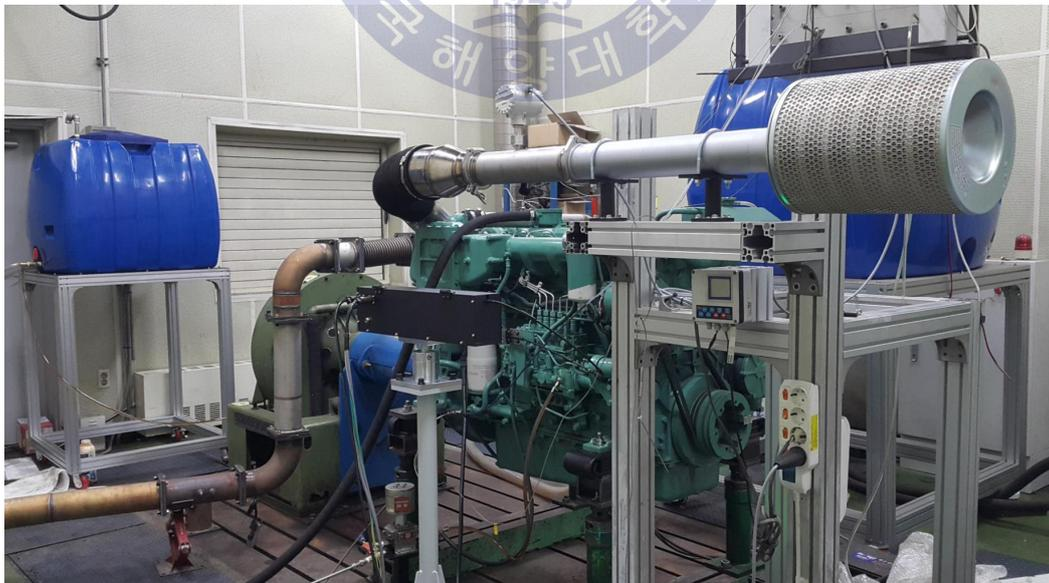
**Fig. 4.9** 두산 L126TIH 엔진시험 및 배기가스측정 장치의 전경
