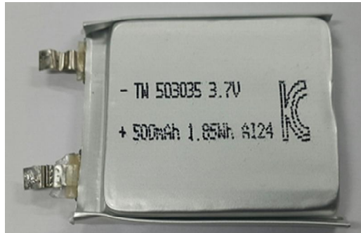
Fig. 23 Li-ion battery(3.7V 500mAh)
