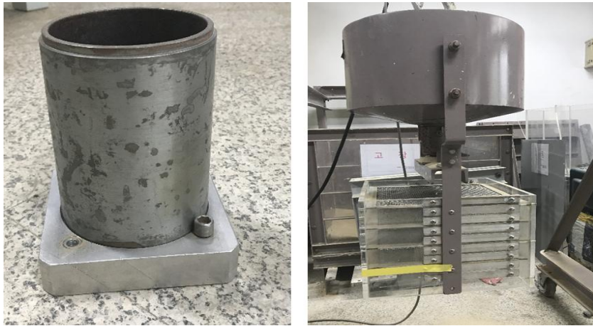
Fig. 11 상대밀도 장치(원형몰드, 강사장치)
