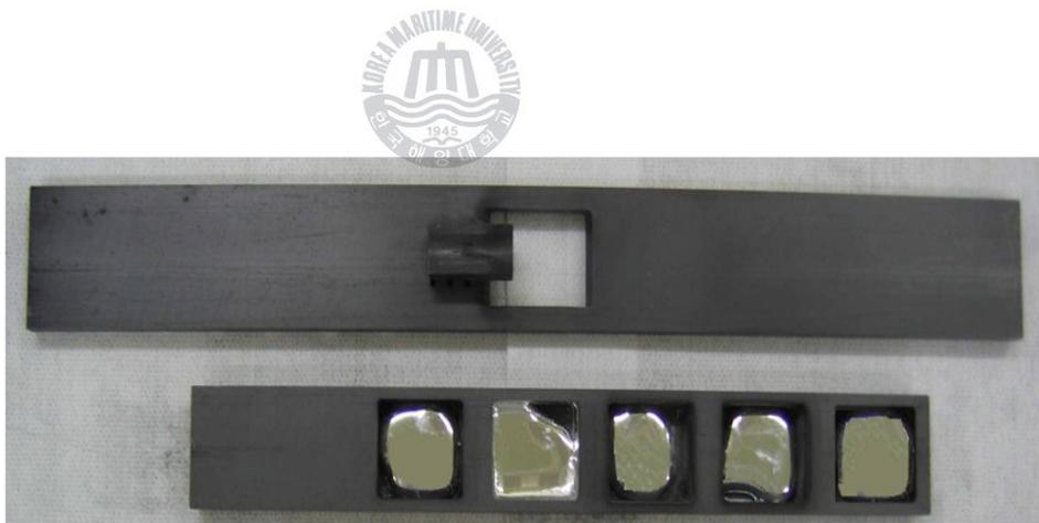
그림 2.2.2 multi-sliding boat의 실제 사진
