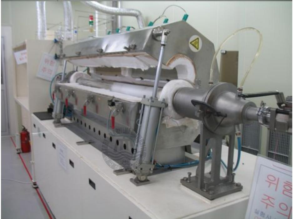
그림 2.1.5 혼합소스 HVPE 장치의 사진
