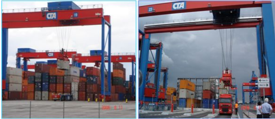
<그림 3-4> CTA 해측 블록작업(AGV) / CTA 육측 블록작업(R/T)
