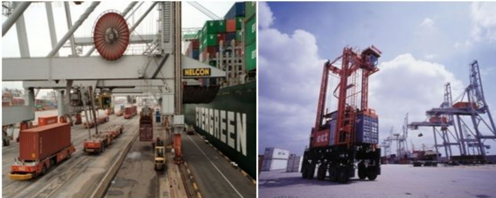
<그림 2-10> 안벽 작업전경-AGV / 컨테이너 역내 이송-SC
