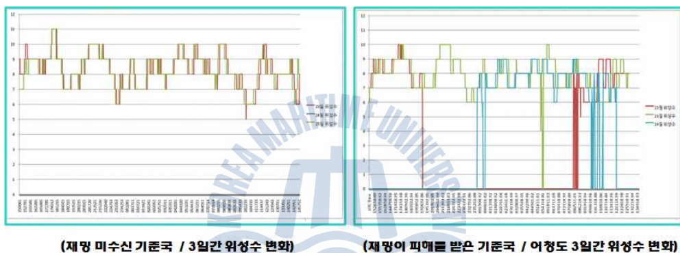
<Fig. 2-9> DGPS 시스템의 전파교란 사례
