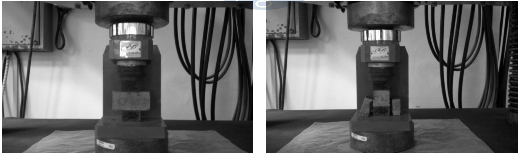
<그림 4-11> 모르타르 압축강도 측정
