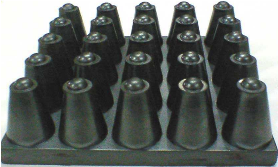
그림 3.20 실제 제작된 전파흡수체 Fig. 3.20 Fabricated EM wave absorber.
