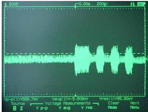
그림 5.9 일반 송·수신 겸용 펄스 트랜스를 사용하였을 때 수신측 신호
