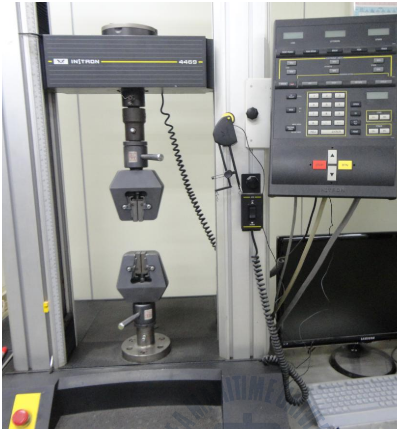
Fig. 5 Tensile test machine (Instron 4469).
